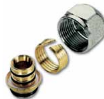
RACCORDO ADATTATORE IN OTTONE PER TUBI POLIBUTENE/MULTISTRA- TO/PEXA PE-RT \varnothing 12 \div 20 mm CALOTTA EUROCONO 3/4"
